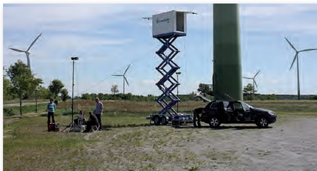
Mit einem mobilen Messlabor untersuchte das Forschungsteam in einer ersten Kampagne die Leistungsbeeinflussung von Radaranlagen durch WEAs.
