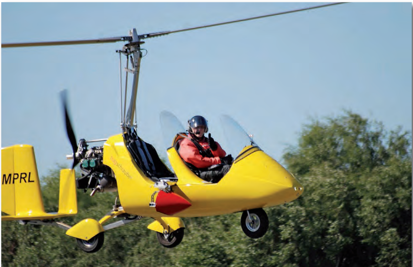
Ein Tragschrauber im Einsatz für das AMLS. Auf dem hinteren Sitz ist das Trägersystem mit der Sensoraußenlast zu erkennen.
