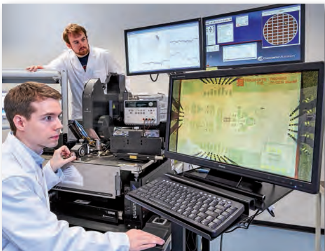
On-Wafer-Prober zur Hochfrequenzvermessung von integrierten Schaltungen.
