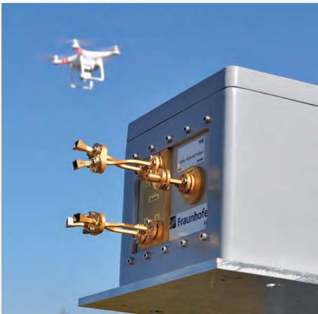
Vierkanalige MuRPS (Multi Channel Radar for Perimeter Surveillance) mit Quadcopter im Hintergrund. Die Winkelablage erfolgt nach dem Monopulsverfahren. Foto: Fraunhofer FHR
