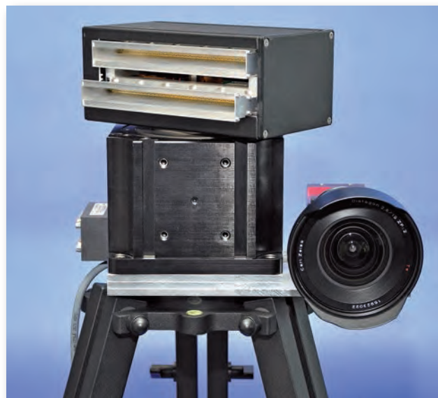
Mechanisch scannendes SSRS (Scanning Surveillance Radar System) mit optischer Kamera. Der rotierende Sensor scannt mit einem Öffnungswinkel von 1,8^\circ in Azimut-Richtung.
