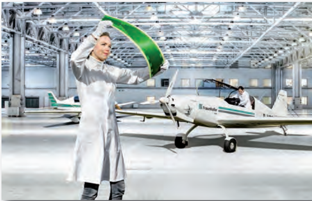
Flexible Antennen können in die Außenhaut von Flugzeugen integriert werden. Somit können gleiche Antennenleistungen erreicht werden, ohne dass die Aerodynamik beeinträchtigt wird.
