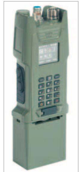
ten Sprengfallen (RC-IED), die über Funk ausgelöst werden. Ein geringes Gewicht von etwa 1 Kilo, einfache Bedienung und lange Batterielaufzeit von mindestens acht Stunden zeichnen die bereits bei mehreren NATO-Mitgliedsstaaten im Einsatz befindlichen Systeme aus. Die Geräte werden in Großbritannien hergestellt und gehören zur Jammer STORM-H Familie.
