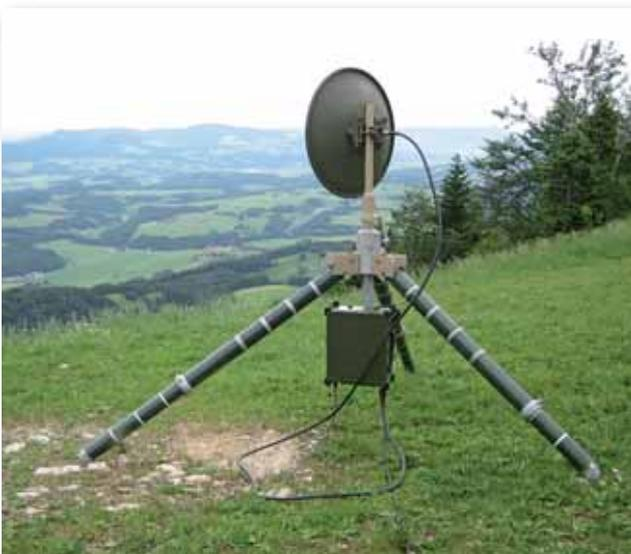
*SELEX – Richtfunksystem MH 544 (Band IV) in Außenanwendung mit Dreibein. SELEX Richtfunkgeräte werden eingesetzt im Projekt TITAAN der Niederländischen Streitkräfte.*
