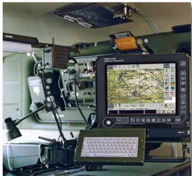
*Rheinmetall Iniochos – Um die Aufklärungsdaten unterschiedlicher Sensoren schnell aufzubereiten und für die Operationsführung von Großverbänden verfügbar zu machen – dafür bietet Rheinmetall Defence Electronics C3I-Systeme an, die kontinuierlich einen detaillierten Lageüberblick ermöglichen.*
