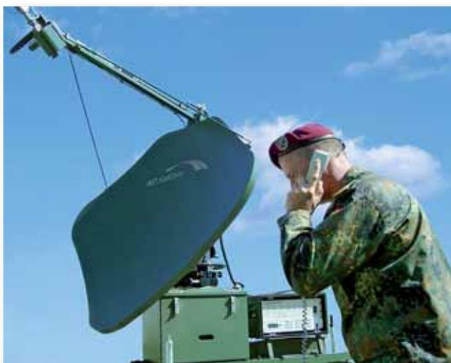
ND SatCom - MFT1915 FlyAway – robust und zuverlässig für die sichere Kommunikation und Datenübertragung per Satellit
