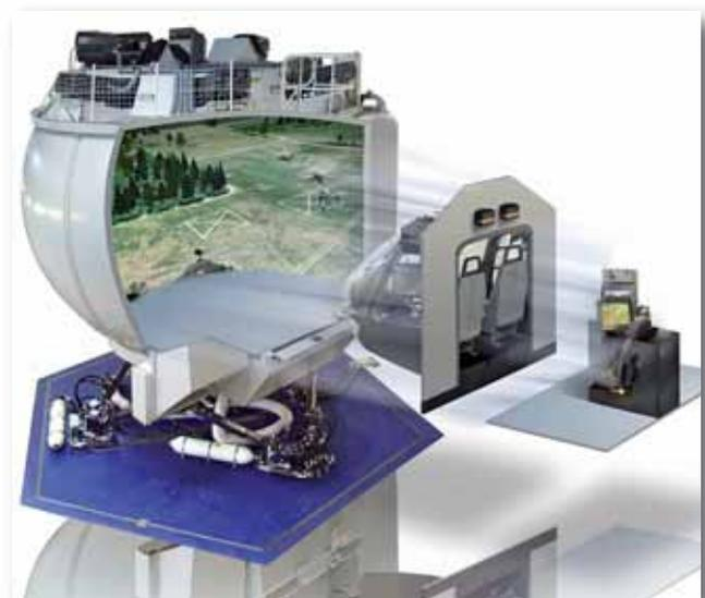
*Modulare Simulationssysteme mit Wechsel-Cockpit*
