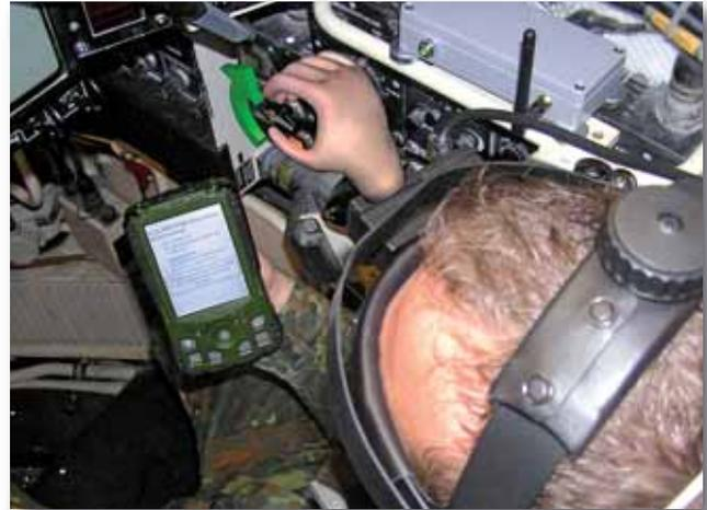
*Telemaintenance-Unterstützung für das Instandsetzungspersonal am Einsatzort mittels Augmented Reality*
