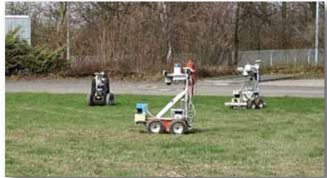
Abbildung 2: Eine Robotergruppe aus drei Robotern, die auf Befehl in der Formation "wedge" vorrücken.
