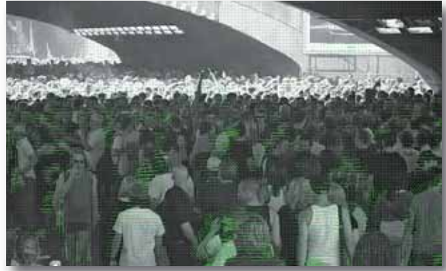
Die Videoanalyse-Software des Fraunhofer IAIS erkennt kritische Bewegungsströme und detektiert potenzielle Gefahrensituationen in Menschenmengen.
