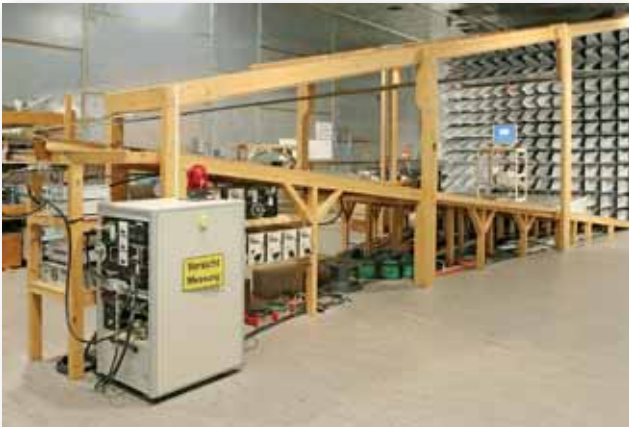
Feldsimulator des INT zur Ermittlung der Störschwellen von Geräten und Systemen
