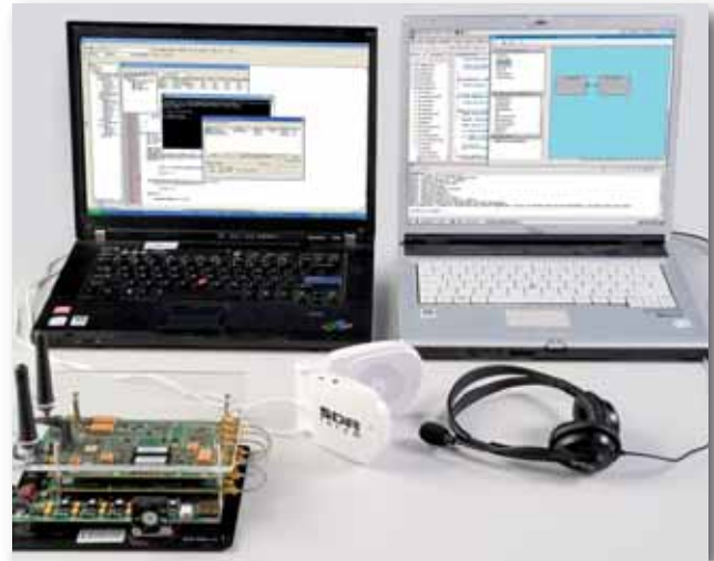
Wellenformentwicklungsumgebung für Software Defined Radio
