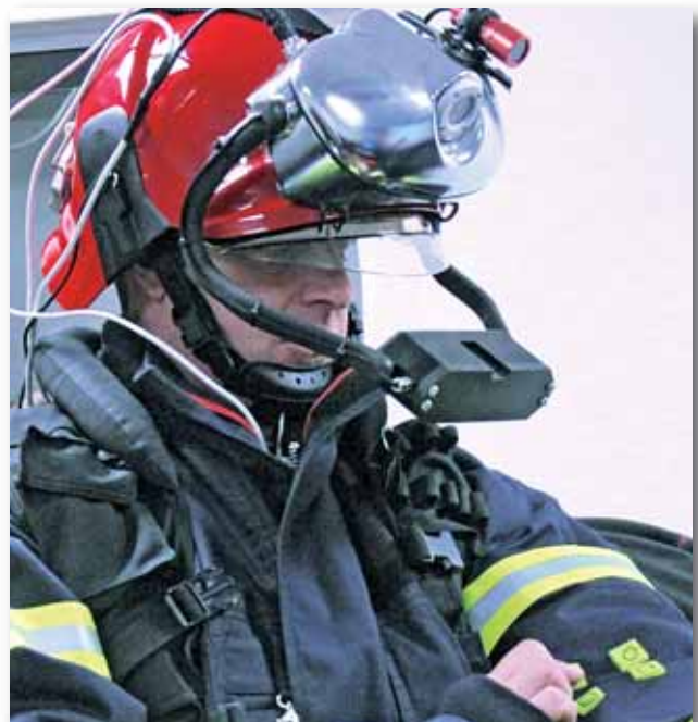
Feuerwehrmann bei der Erprobung eines Prototypen zur Unterstützung taktischer Navigation
