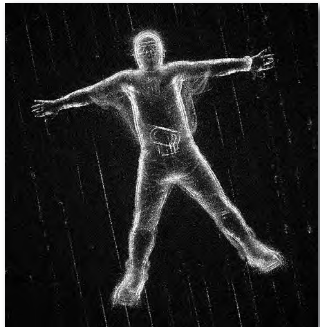
ISAR-Messung einer Person in 140 Meter Entfernung mit dem höchstauflösenden Radar MIRANDA 300
