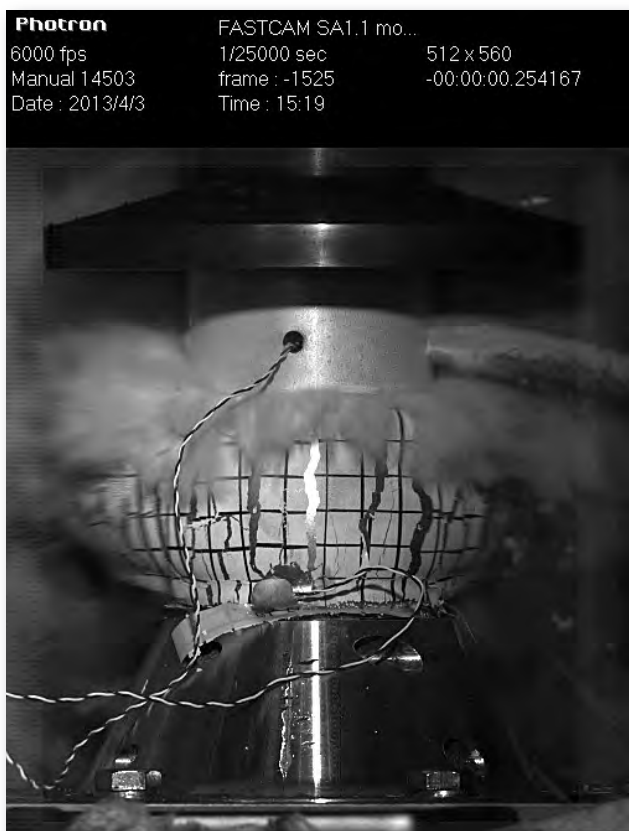
Stauchversuch an einer Li-Ionen-Zelle: HS-Videobild der explodierenden Zelle. Foto: Fraunhofer EMI
