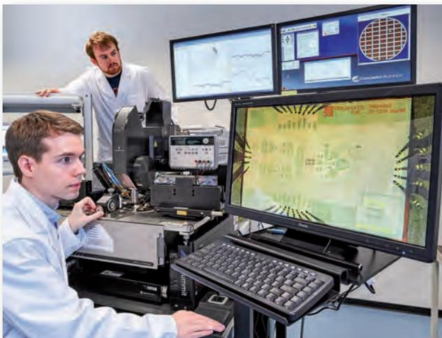
*On-Wafer-Prober zur Hochfrequenzvermessung von integrierten Schaltungen.*
