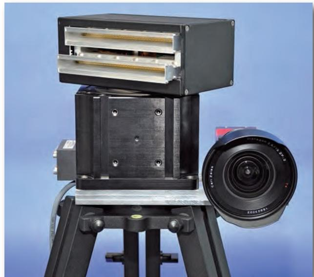
*Mechanisch scannendes SSRS (Scanning Surveillance Radar System) mit optischer Kamera. Der rotierende Sensor scannt mit einem Öffnungswinkel von 1,8° in Azimut-Richtung.*
