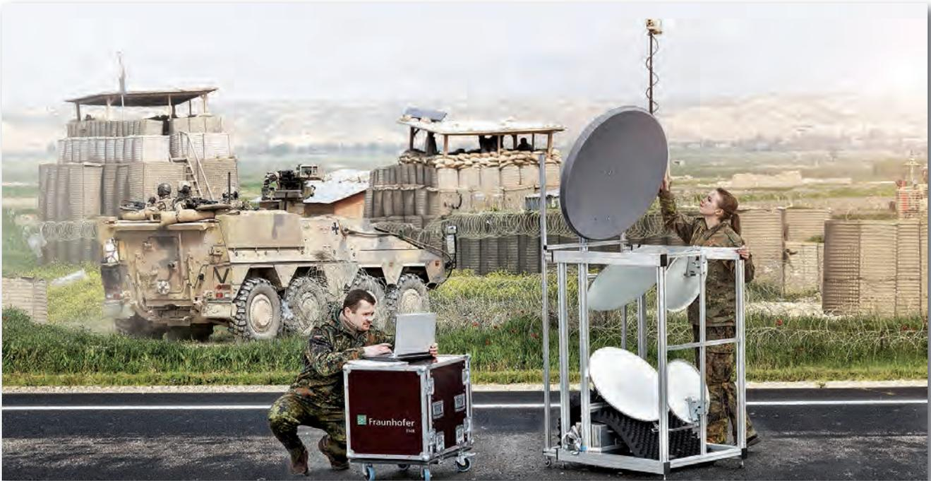
Mögliches Einsatzszenario zum Feldlagerschutz des TAARDIS-Systems, einem abbildenden radiometrischen Scanner.
