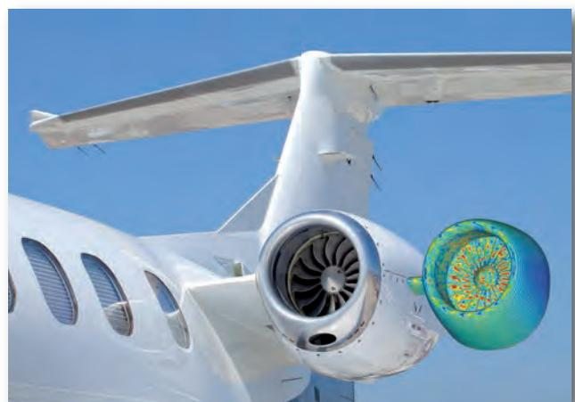
Reales Triebwerk und simulierte Verteilung von Oberflächenströmen auf einem Triebwerksmodell Foto: Fraunhofer FHR & istockfoto
