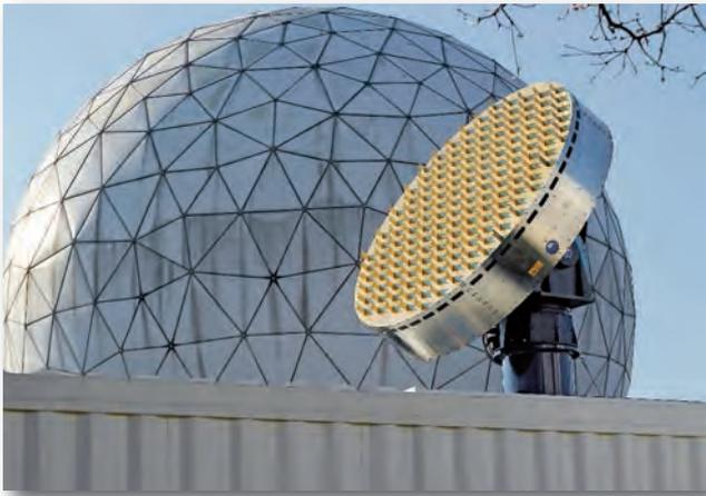
Abbildung 2: Phased-Array-Antenne zum Einsatz in der Weltraumüberwachung
