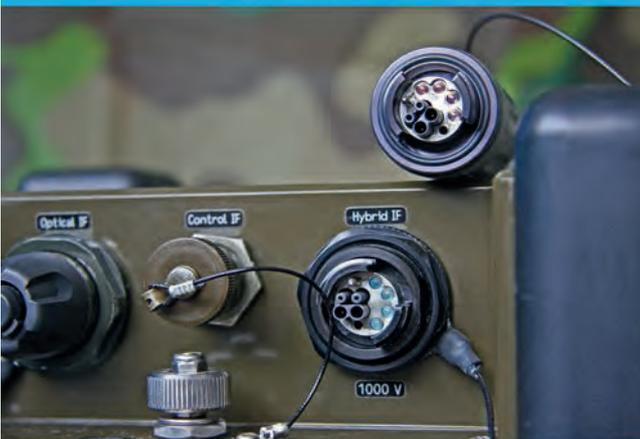
Brugg Kabel entwickelt kundenspezifische Hybridlösungen. Diese Technologie erlaubt einzigartig schnell verlegbare, weiträumige integrierte Gb/s-Daten- und kW-Stromnetze für Kommunikationsinfrastrukturen.
