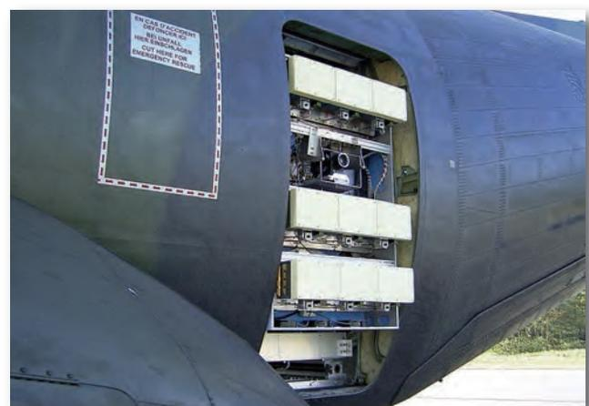
Abbildung 1: Simultane Along- und Across-Track-Aperture von PAMIR
