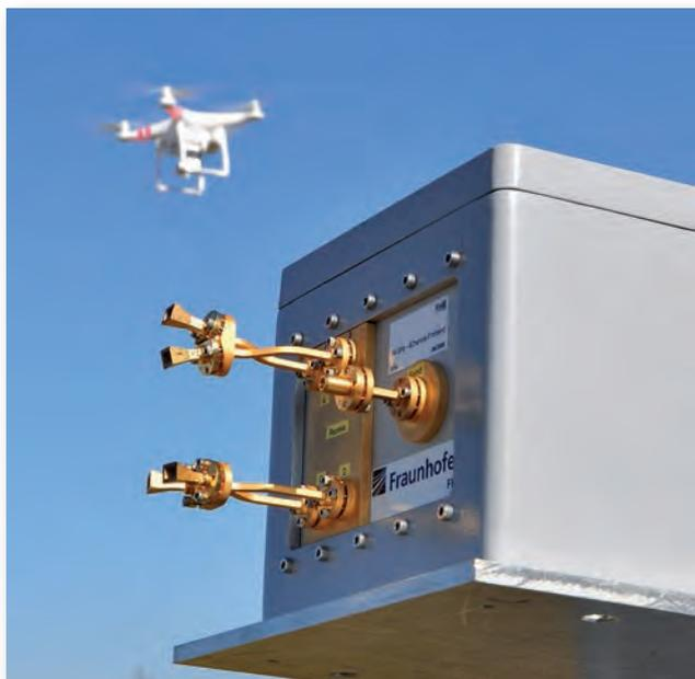
Vierkanalige MuRPS (Multi Channel Radar for Perimeter Surveillance) mit Quadrocopter im Hintergrund. Die Winkelablage erfolgt nach dem Monopulsverfahren. Foto: Fraunhofer FHR
