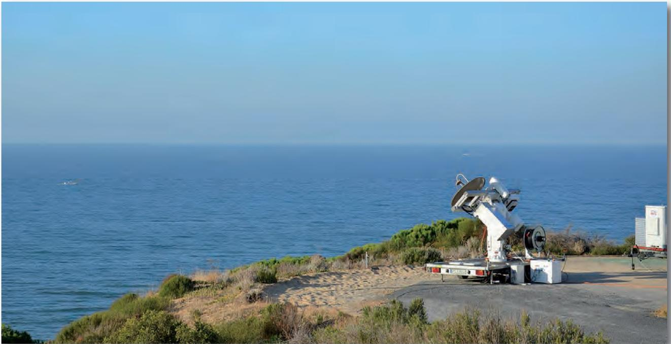
Abb. 3.: MOBIDAR System zur Vermessung von Zielsignaturen
