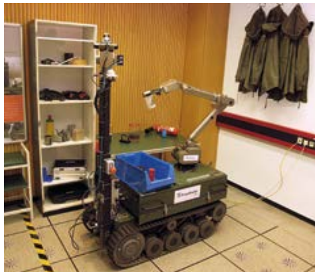
Das UGV sammelt mittels „Click & Grasp“-System beliebige Gegenstände im Labor ein.
