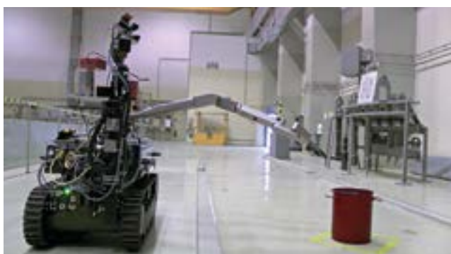
AKW Zwentendorf: Das UGV sichert radioaktives Material.
