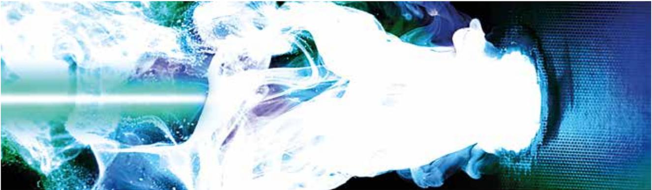
Verdampfungsprozesse in einer laserbestrahlten Probe aus kohlenstofffaserverstärktem Kunststoff.
