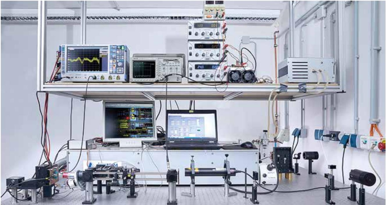
*Messsystem zur Simulation von Single-Event Effects in geöffneten elektronischen Bauteilen mittels fokussierten Pikosekunden-Laserpulsen.*
