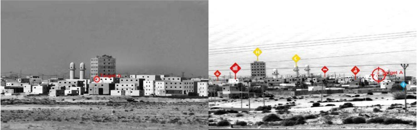
Links: Sicht eines Sensors aus Position A, der ein Ziel markiert; Rechts: Sicht eines Richtschützen aus Position B mit augmentierter Lage in der Waffenoptik.
