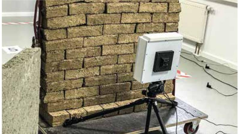
*Radartechnologie ist das Auge des Systems, KI das Gehirn: Das Radargerät sendet und empfängt Wellen durch Hindernisse, hier eine Lehmziegelwand, und übergibt die Daten an den KI-Algorithmus, der dann seine Prognose hinsichtlich der Standorte von Personen auf einem Bildschirm darstellt.*
