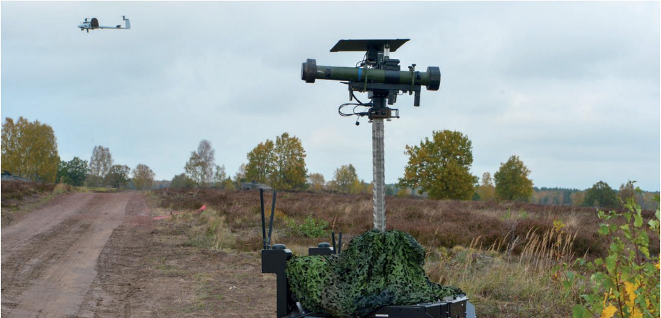
Zippermast mit Wirkmittel auf UGV Gereon (ARX Landsysteme), Drohne in der Luft
