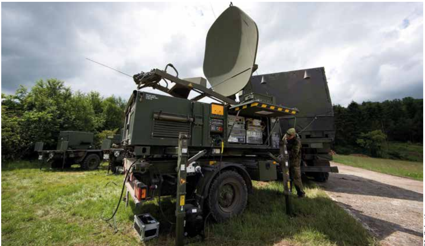
Die Bodenstation von SATCOMBw ist Teil des Service Delivery Point: Im Gefecht folgt der Service Delivery Point dem Gefechtsstand und stellt durch die Kommunikationsanbindung die Führungsfähigkeit sicher.
