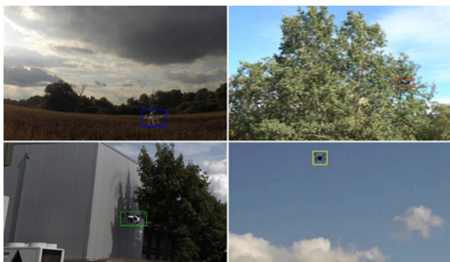
Die am Fraunhofer IOSB entwickelten Videoauswerteverfahren detektieren Drohnen auch vor schwierigen Hintergründen und unterscheiden sie zuverlässig von anderen Objekten wie etwa Vögeln. Foto: Fraunhofer IOSB
